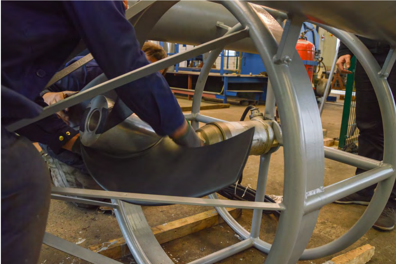
Abb. HKT PT2 Montage Generator und Laufrad
