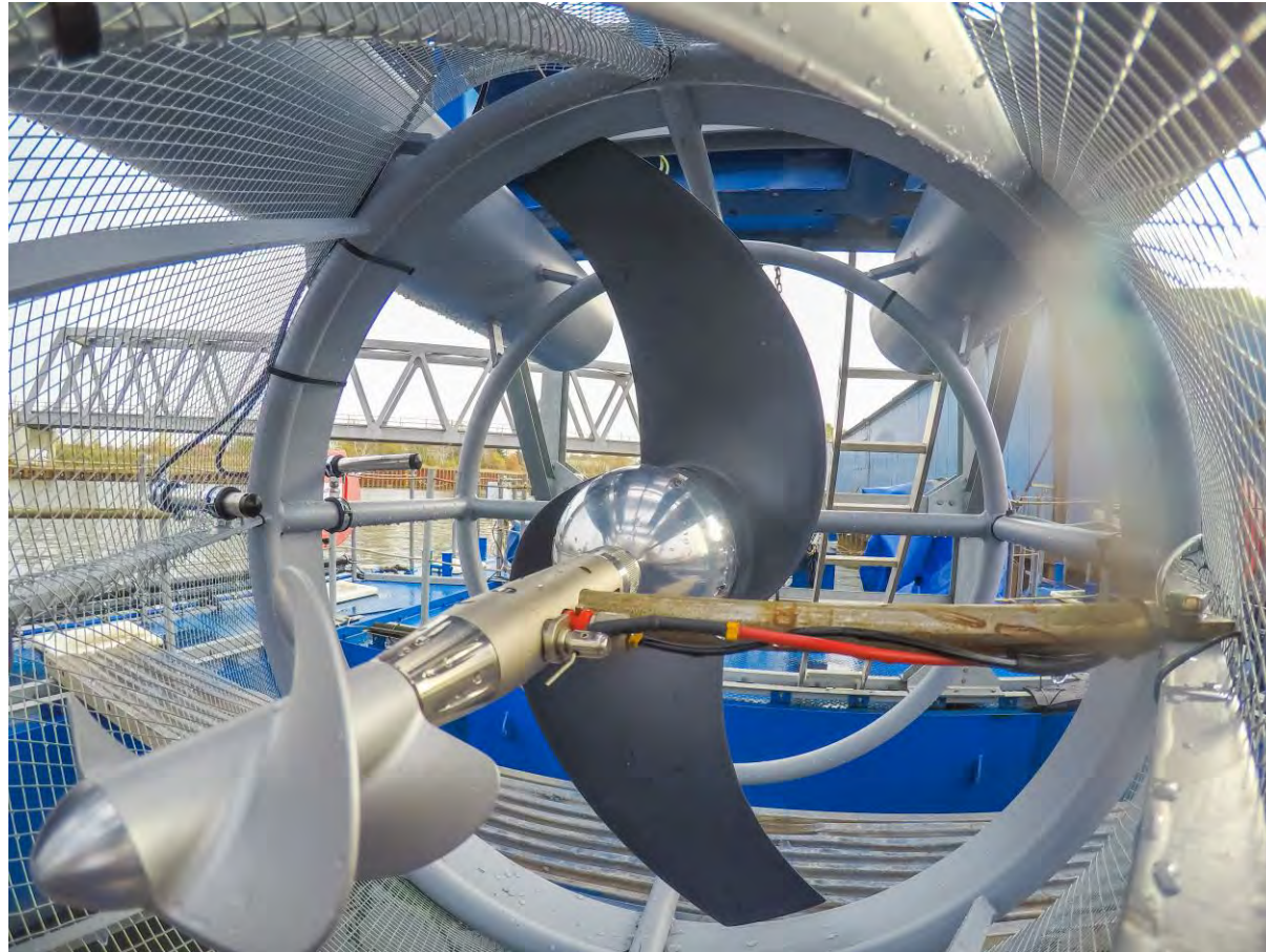
Abb. HKT PT2 Details Messsensorik
