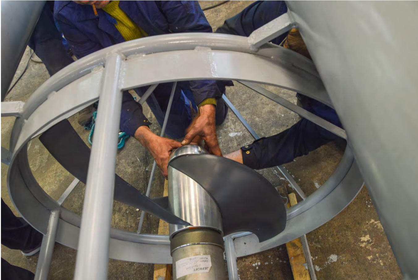
Abb. HKT PT2 Montage Laufrad
