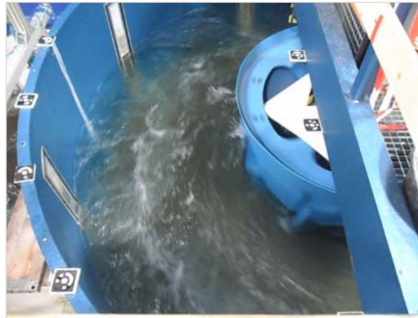
Wirbelbecken mit Turbinenrad im Betriebszustand
