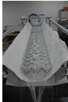
Strömungsversuchs- stand Zick-Zack-Matte
