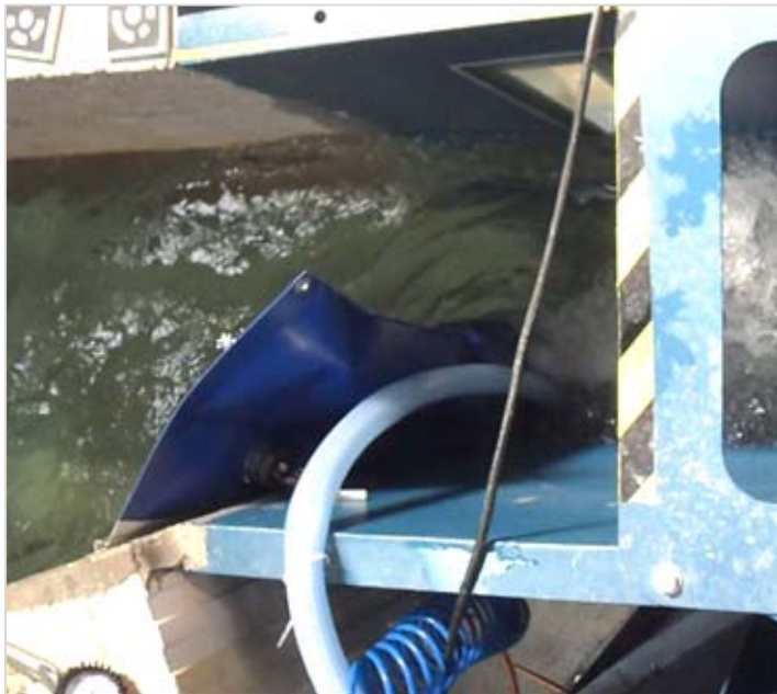
Hydraulisch angetriebenes Textil zur Strömungsbeeinflussung im Einlaufkanal
