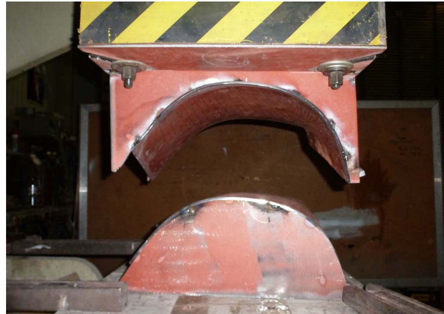
Formgebung durch Tiefziehen
