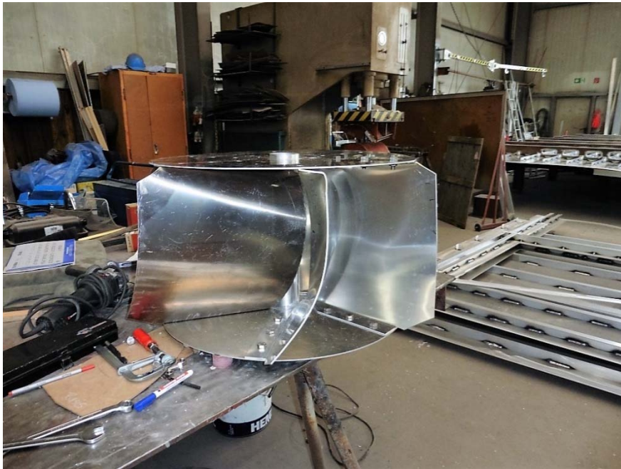
Wasserrad mit AlMG 3 - Beschaufelung
